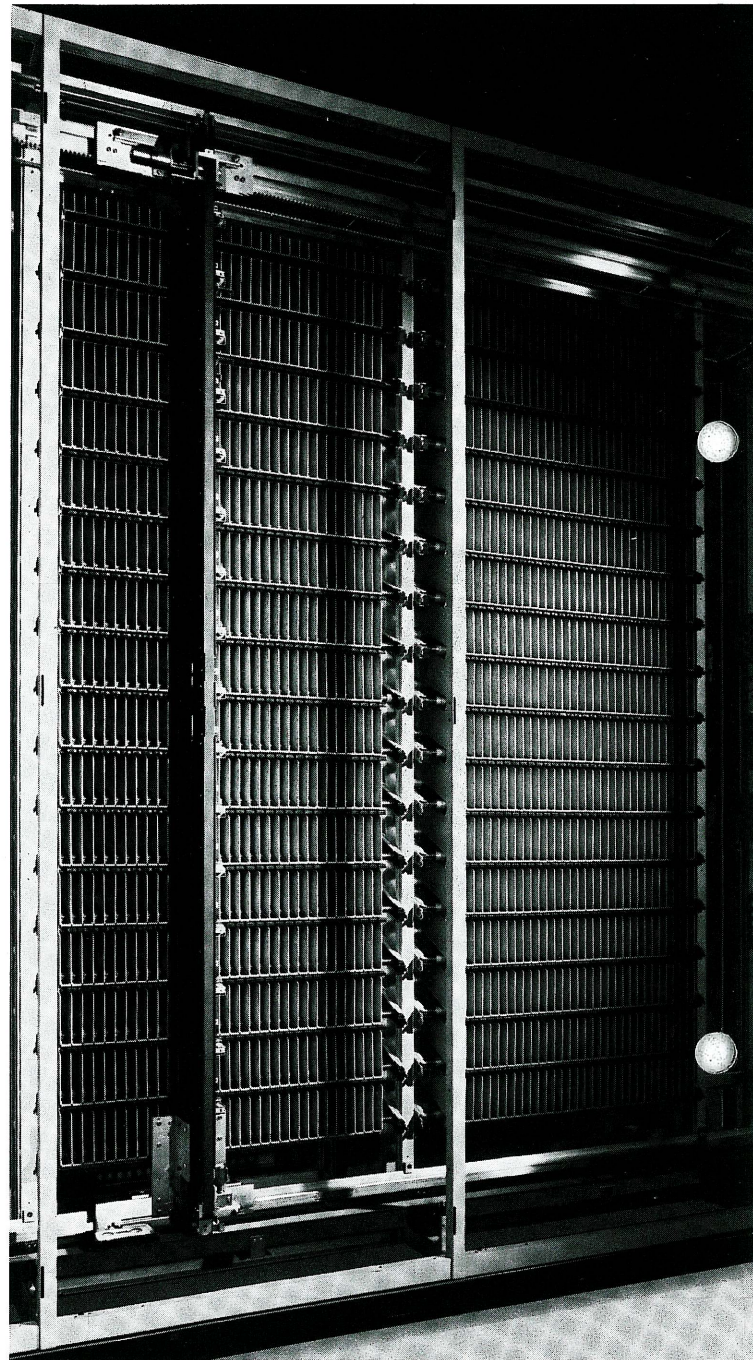
Teilansicht des modularen Cassettenarchives mit 2 Einheiten für je 1024 Cassetten. Links: der über Zahnriemen geführte, fahrbare Auslagerschacht. Unten: das Auslagerband; rechts: die Steuerelektronik. Das Archiv ist symmetrisch aufgebaut; zwischen den vorderen und hinteren Cassettenregalen bewegt sich der Einlagerlift.
