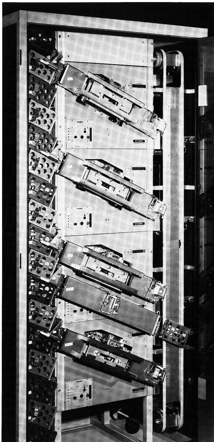
Spielerturm (Basis), allseitig geschlossen, vorne mit Rauchglastüre. Linke Seite: Einlagerspeicherkette, voll bestückt mit 43 Cassettentaschen; rechte Seite: Auslagerspeicherkette, hier nur mit einer Cassettentasche bestückt.
