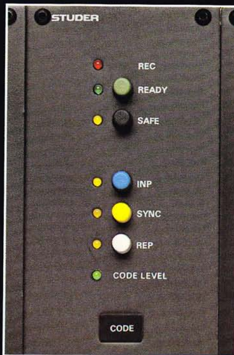
Zeitcode-Kanalsteuerung mit Codepegel-Indikation.
