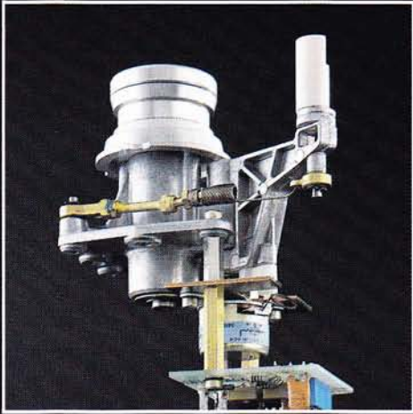
Stabilität auch im Kleinen: Bandzugsensor mit Keramikführungen (bis 1/2" Band).
